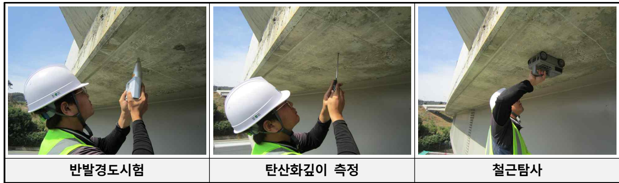
[그림 4.1.1] 비파괴시험 수행 사진
