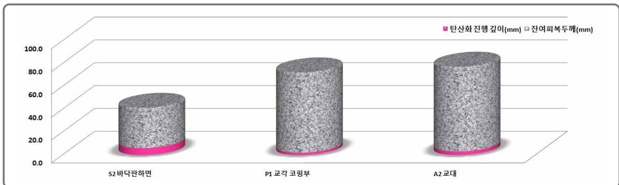
[그림 4.2.3] 탄산화깊이 및 잔여피복두께 측정결과
